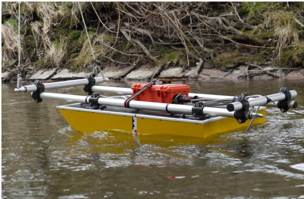
*Geräteträger mit Sensoren und Elektronik in wasserdichtem Gehäuse.*
