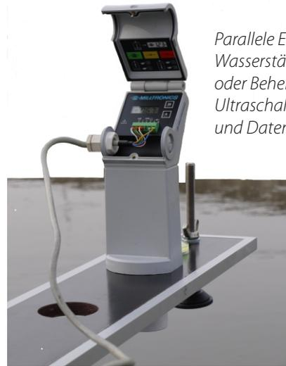
*Parallele Erfassung der Wasserstände von Brücke oder Behelfspegel mit Ultraschall Laufzeit Sonde und Datenlogger.*
