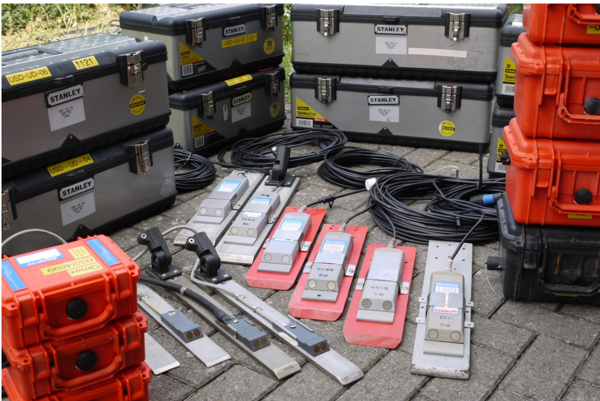
Ultraschall-Doppler-Kombisonden als Langzeitmessung im Kanal
