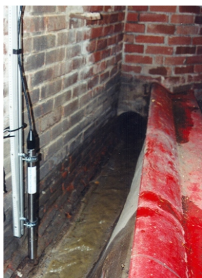
Drucksonde mit integriertem Datenlogger
