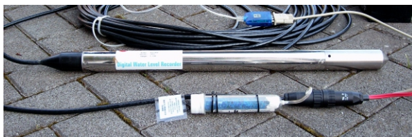
Wasserstandserfassung im Kanal DN 2000 bei einem Starkregenereignis
