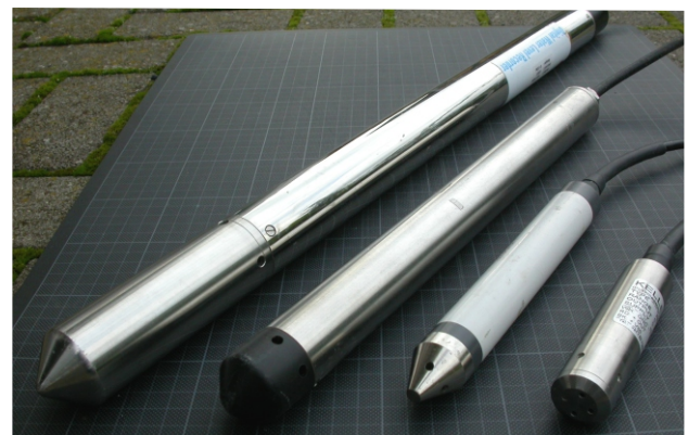
Drucksonden für verschiedene Einsatzzwecke und Messbereiche
